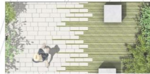
PARKINGS : Système de pavés avec végétation RINN - SCHWAMMSTADT SYSTEM 1
