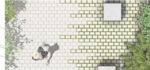
AMENAGEMENTS PIETONS : Système de pavés avec végétation RINN - SCHWAMMSTADT SYSTEM 4
